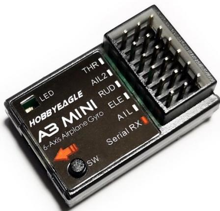
感谢您购买和使用我们的产品。A3 Mini 是一款专门为固定翼模型飞机设计的高性能迷你型 6 轴陀螺仪和平衡仪。更小的尺寸和紧凑的外形设计非常适合在小型电动飞机或室内飞机上使用，多协议的串行接收机支持可以轻松地与市面上常见的迷你接收机进行单线连接。为了让您更好地了解和使用本产品和安全飞行，请认真阅读本说明书并按说明书的要求进行相关设置。
